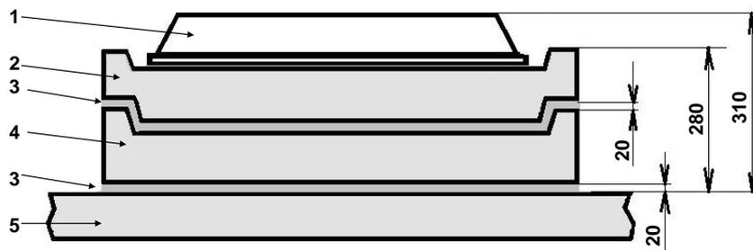
Рис. 14. Высота горловины с парой колец КО-ЧП и КО-Ч:
