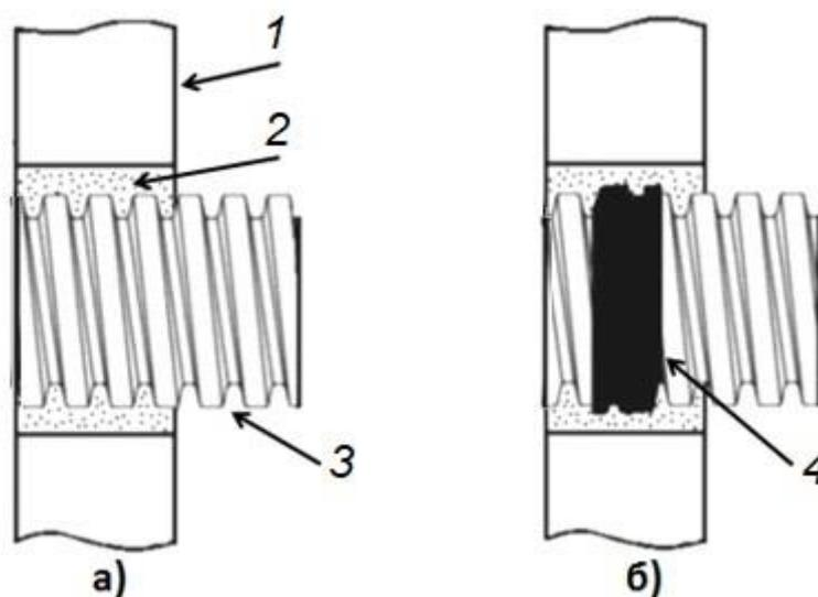
Рис. 10. Ввод трубы типа «ССД-Пайп» в стену железобетонного колодца:
