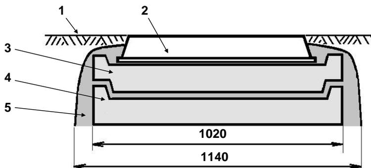
Рис. 15 Диаметры колец и обмазанной бетоном горловины при использовании пары «КО-ЧП» и «КО-Ч»:
