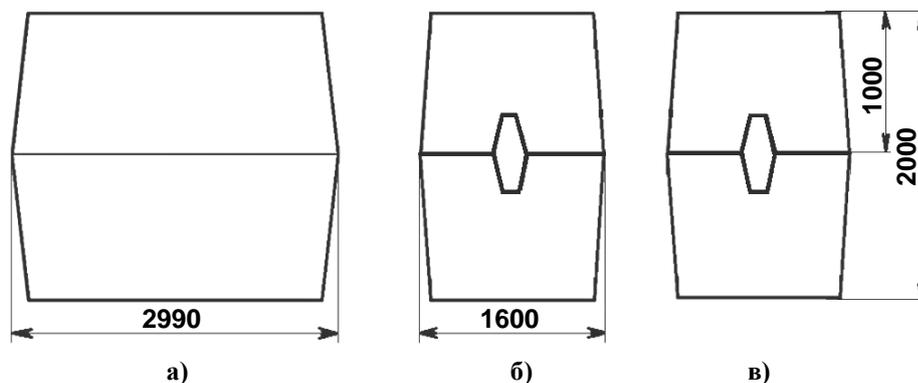
Рис. 5. Габаритные размеры колодца «ККСр-5-10»:
