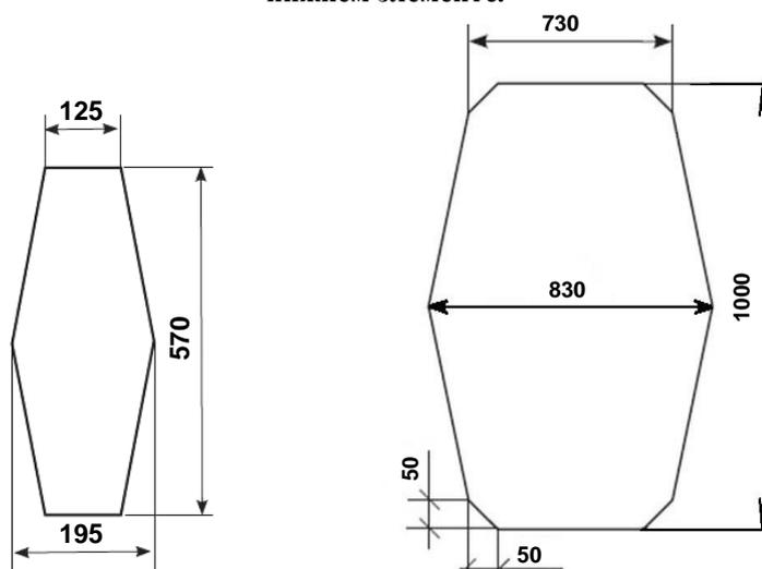
**Рис. 2.2. Размеры технологического отверстия и участка с тонкой
