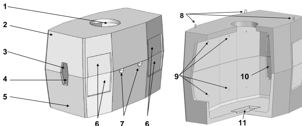
Рис. 4. Колодец «ККСр-5-10», внешний вид и детали элементов колодца:
