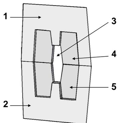
**Рис. 2.1. Участок с тонкой неармированной стенкой
