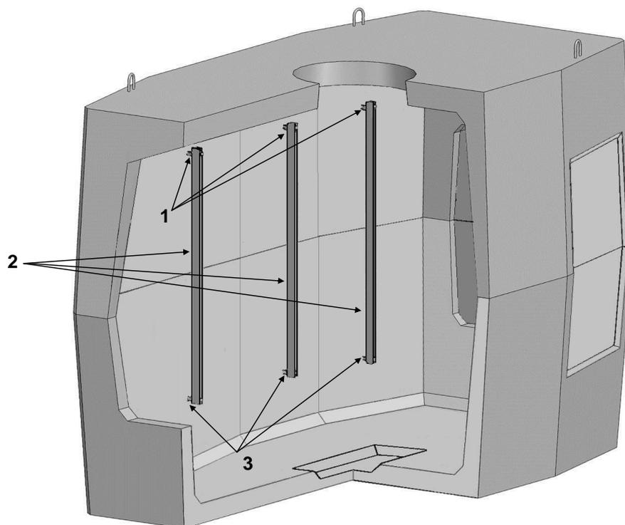
Рис. 3.1. Кронштейны «ККП-130» на боковой стене колодца «ККСр-5-10»: 1 – ёрши в верхнем элементе; 2 - кронштейны; 3 – ёрши в нижнем элементе.
