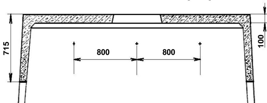
Рис. 9. Размеры колодца «ККСр-5-10» на продольном разрезе верхнего элемента: толщина перекрытия; расстояние от перекрытия до технологического отверстия; расстояние между отверстиями для ершей.
