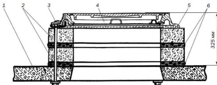
Рис. 16. Крепление опорных колец и люка с помощью «СНКЛ-3»:
