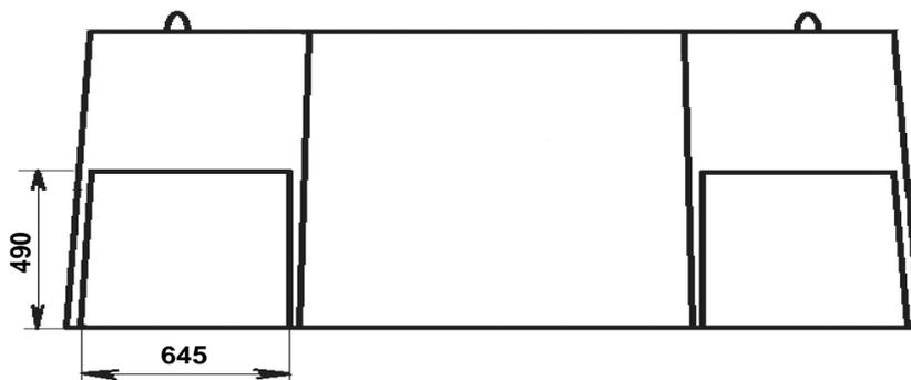
Рис. 8. Размеры ниш на примере верхнего элемента колодца «ККСр-5-10». На нижнем элементе ниши такого же размера.
