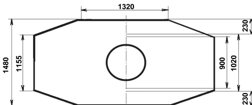
Рис. 7. Размеры перекрытия колодца «ККСр-5-10» с указанием диаметров опорных колец: 900 мм – кольца типа КО; 1020 мм – колец КО-ЧП и КО-Ч.
