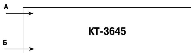
Схема “а”: прямой односторонний ввод
