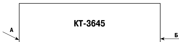
Схема “в”: комбинированный (прямой и угловой) разносторонний ввод
