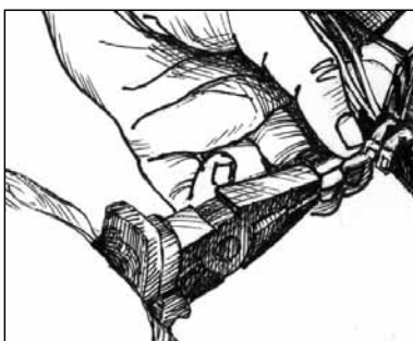
Рисунок 4.49 - Крепление ОМ на вводе в кассету
