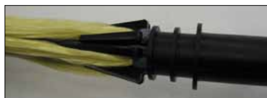
Рисунок 4.4 - Распределение нитей между лепестками штуцера
