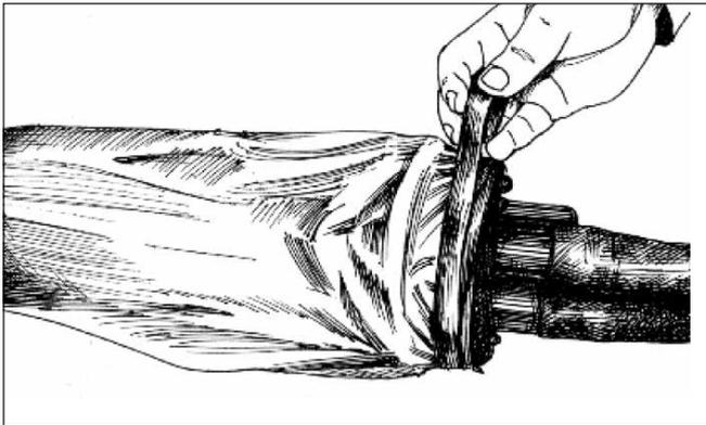
**1** Надвинуть на смонтированную муфту МТОК 96 малый полиэтиленовый пакет. Закрепить пакет на оголовнике муфты МТОК 96 лентой ПВХ.
