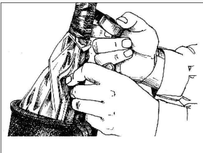
**4** Не дожидаясь подъема уровня саморасширяющегося герметика к горловине муфты МЧЗ, прижать края пакета к введенным кабелям и обмотать лентой ПВХ. Уложить муфту МЧЗ в грунт.
