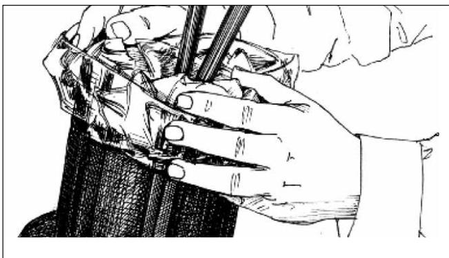
**2** Надвинуть поверх малого пакета большой полиэтиленовый пакет. Уложить муфту МТОК 96 в полукорпус МЧЗ; края большого пакета вывести из горловины МЧЗ. Установив на полукорпус МЧЗ другой полукорпус, скрепить их болтами с шайбами и гайками.
