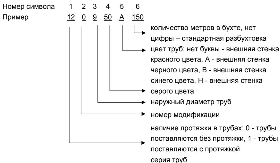
Рисунок 4.1 – Структура условных обозначений двустенных труб ЗАО «ДКС»
