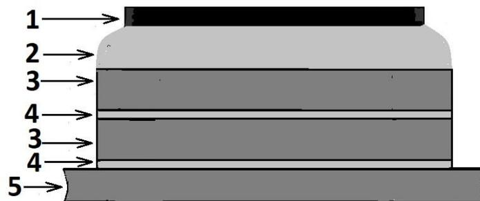
**Рис. 11. Внешний вид горловины, сформированной с применением набора «СНКЛ-4 ССД» после обмазывания бетоном верхнего кольца и корпуса люка:**
