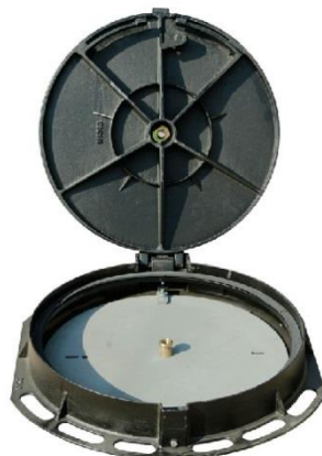
Рис. 2. Устройство УЗЛ-Т ССД с поднятой чугунной крышкой. Крышка удерживается в поднятом положении шарнирным механизмом.
