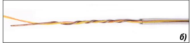
**б)** использовать проволоку ~ Ø 0,5 мм, на конце которой выполнено 3-4 спиральных витка для укладки концов группы ОВ (рисунки "а" и "б").
