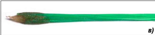
**в)** нанести на конец группы ОВ слой клея-расплава (рисунок "в"):
