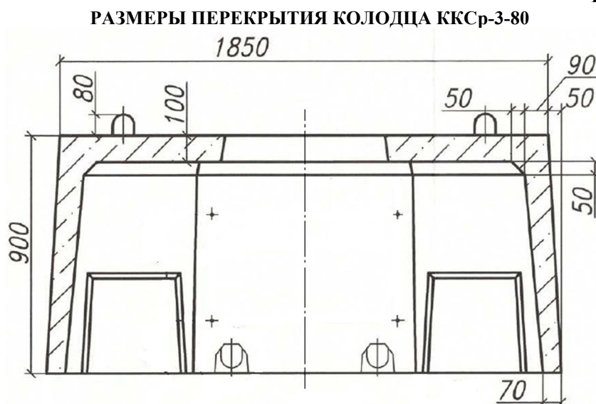
Рис. 1.1. Размеры перекрытия верхнего элемента колодца ККСр-3-80.
