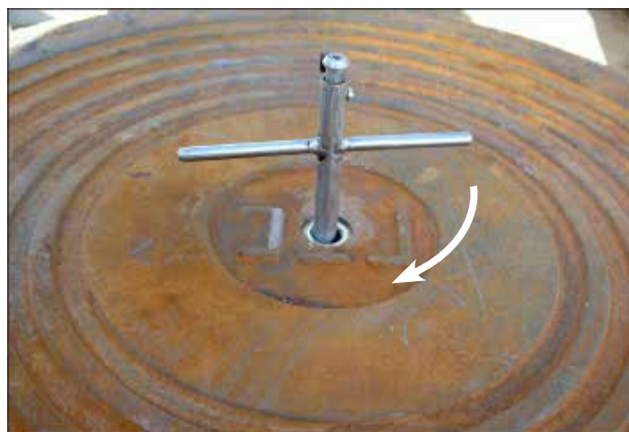
Рисунок 4.3 – Установленный ключ в УЗЛ-Л (УЗЛ-Т)
