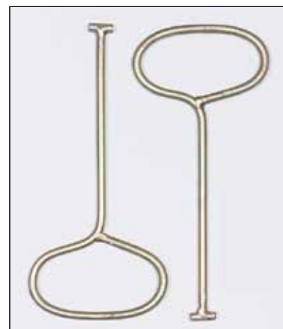
Рисунок 1.4 – Крюки для установки (извлечения): – верхней (чугунной) крышки люка, имеющей пазы; – верхней и нижней крышек УЗЛ-Л (УЗЛ-Т)
