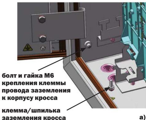
**болт и гайка М6 крепления клеммы провода заземления к корпусу кросса**
